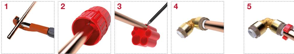
5. Для отцепления просто подденьте выступающую часть расцепляющей втулки.
