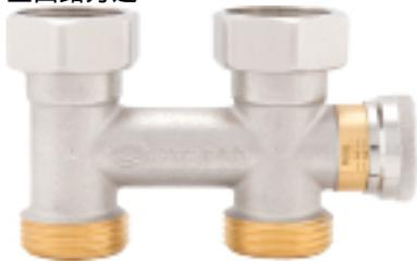
主循环 (可选) 旁通可在主次循环之间进行液压隔离。该液压隔离可优化次循环的运行并防止主循环的流速变化影响次循环。各自循环的流速仅取决于泵的流速特性，避免串联连接产生的相互影响。
