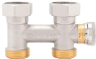
El by-pass para circuito primario (opcional) permite la separación hidráulica entre el circuito primario y el secundario. Esta separación hidráulica optimiza el funcionamiento del circuito secundario e impide que un cambio de caudal del primario influya
