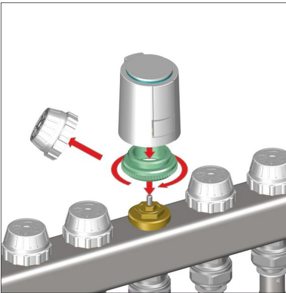
Actionneur électrothermique :
