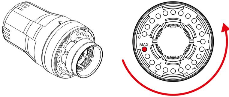
La temperatura MAX può essere limitata spostando il perno di limitazione della temperatura da MAX verso 1.
