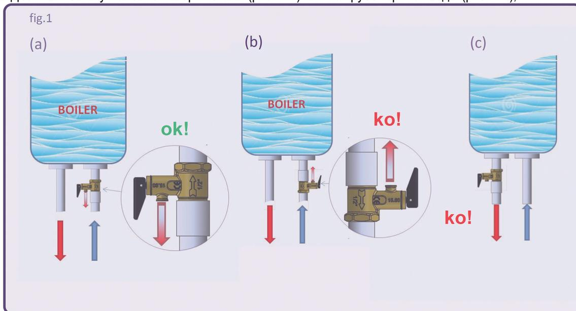
Перед включением водонагревателя переведите рычаг управления в направлении, указанном стрелкой, изображенной на рис. 1, так, чтобы вода начала вытекать из слива. Затем верните рычаг в исходное положение и включите водонагреватель.
