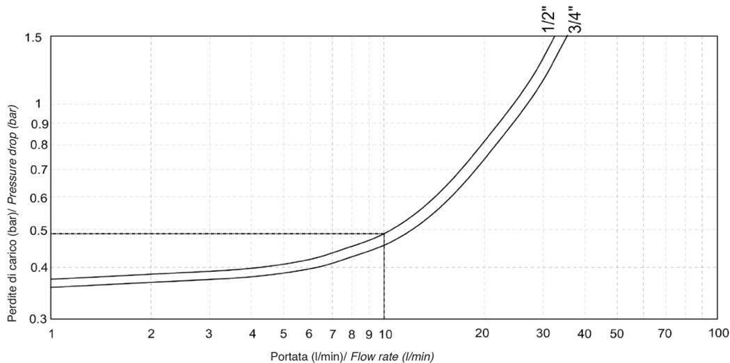
此处提到的数字指：上游压力 8 bar，下游压力 3 bar
