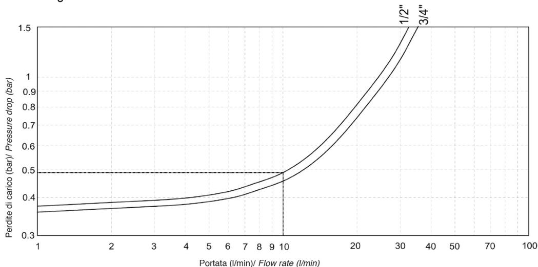
Los valores indicados han sido calculados con una presión aguas arriba de 8 bar y una presión aguas abajo de 3 bar.
