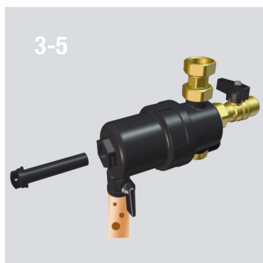
Демонтаж магнита (поверните на 90° по часовой стрелке)
