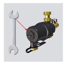
Per ispezionare completamente il defangatore o per pulire o sistituire la cartuccia filtrante è possibile svitare completamente il bicchiere aiutandosi con una normale chiave inglese da CH 29. Lubrificare gli o-ring con grasso idoneo per EPDM.
