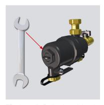
Für eine vollständige Inspektion des Schlammabscheiders oder zum Reinigen oder Austausch der Kartusche lässt sich der Behälter mit einem normalen Schraubenschlüssel SW 29 ganz abschrauben. Die O-Ringe mit einem EPDM-geeigneten Fett schmieren.
