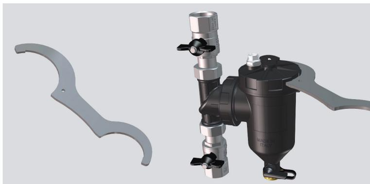
Чтобы полностью осмотреть дешламатор либо чтобы очистить или заменить фильтрующий картридж, можно полностью открутить верхнюю пробку с помощью имеющегося в комплекте гаечного ключа.
