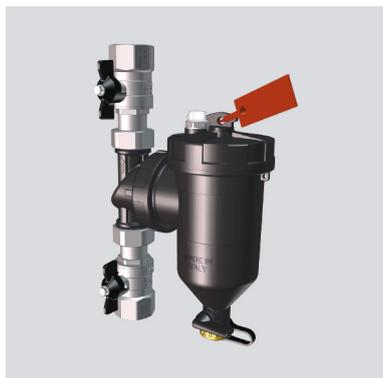
Можно защитить магнит от случайного демонтажа, поставив пломбу (которая поставляется в комплекте) в соответствующий паз на конце, доступном через верхнюю пробку. На пломбе есть язычок для указания даты последней чистки.
