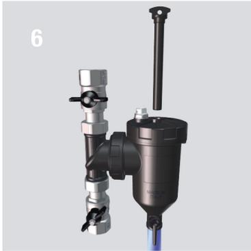
Apertura de la válvula de interceptación aguas arriba y lavado de las partes internas.
