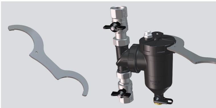
Para inspeccionar completamente el desfangador o para limpiar o sustituir el cartucho filtrante es posible desenroscar completamente el tapón superior mediante la llave en dotación.
