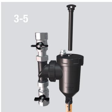
Apertura de la válvula de desagüe.
