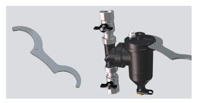
若要彻底检查除泥器或清洁/更换滤芯,可用提供的扳手完全卸下杯。
