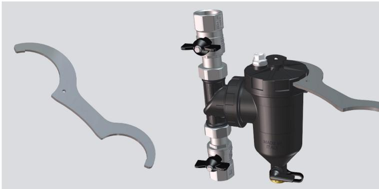
Für eine vollständige Inspektion des Schlammabscheiders oder zum Reinigen oder Austausch der Kartusche lässt sich die obere Kappe mit dem mitgelieferten Gabelschlüssel ganz abschrauben.
