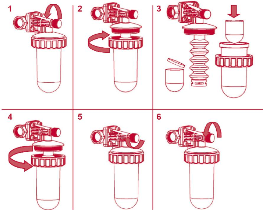
1. 该程序可启动旁通系统。在定量装置下放一个碗。通过逆时针旋转松开放气螺丝，直到水停止流动。
